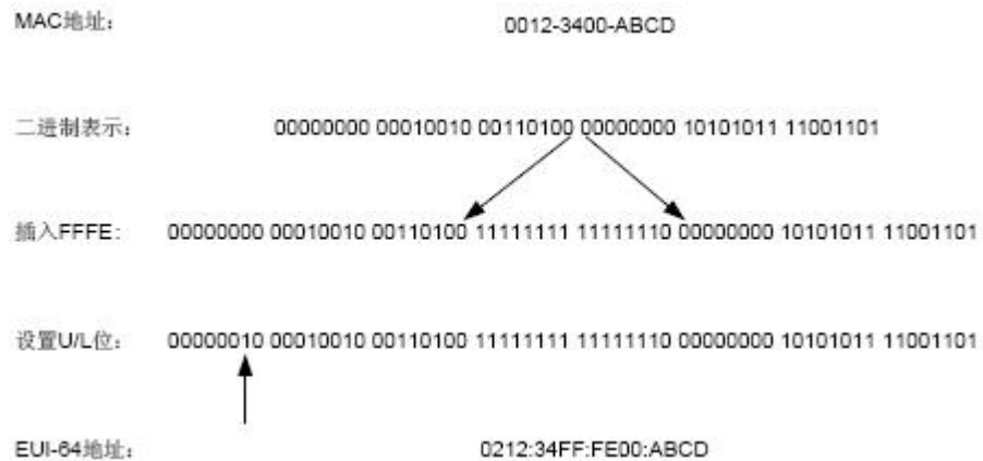
图7-2 MAC地址到EUI-64格式的接口标识符的转换过程
